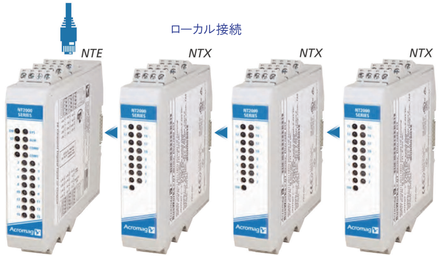
一体型の DIN レール I/O バスコンネクタを介して最大 3 台の NTX 拡張 I/O モジュールを NTE イーサネットモジュールに接続
