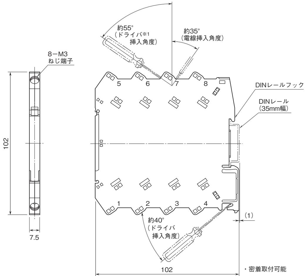
※1、ドライバーの軸径は、6mm以下のものを使用して下さい。
