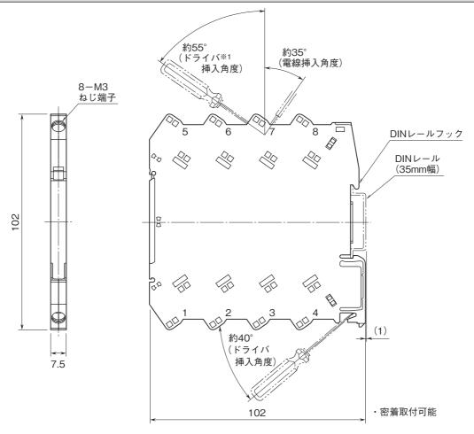
※1、ドライバの軸径は、6mm以下のものを使用して下さい。
